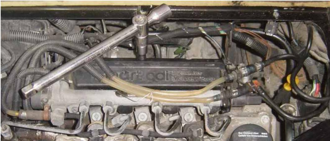
8. Wenn das Gewinde vollständig herausgeschraubt wurde, klemmt die Kerze oft mit dem Schaft in der Gewindebohrung. Unter Mithilfe einer Spitz- oder Gripzange kann dieses knifflige Unterfangen gemeistert werden. Eine andere Idee wäre folgende ;-)
