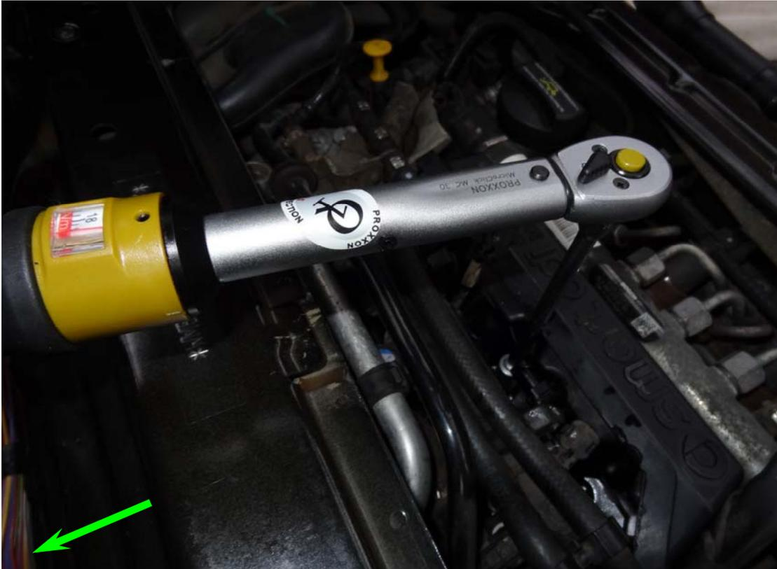
8. Die Stecker auf die Glühkerzen aufstecken, Leitungsbrücke und entsprechende Leitungen montieren.
