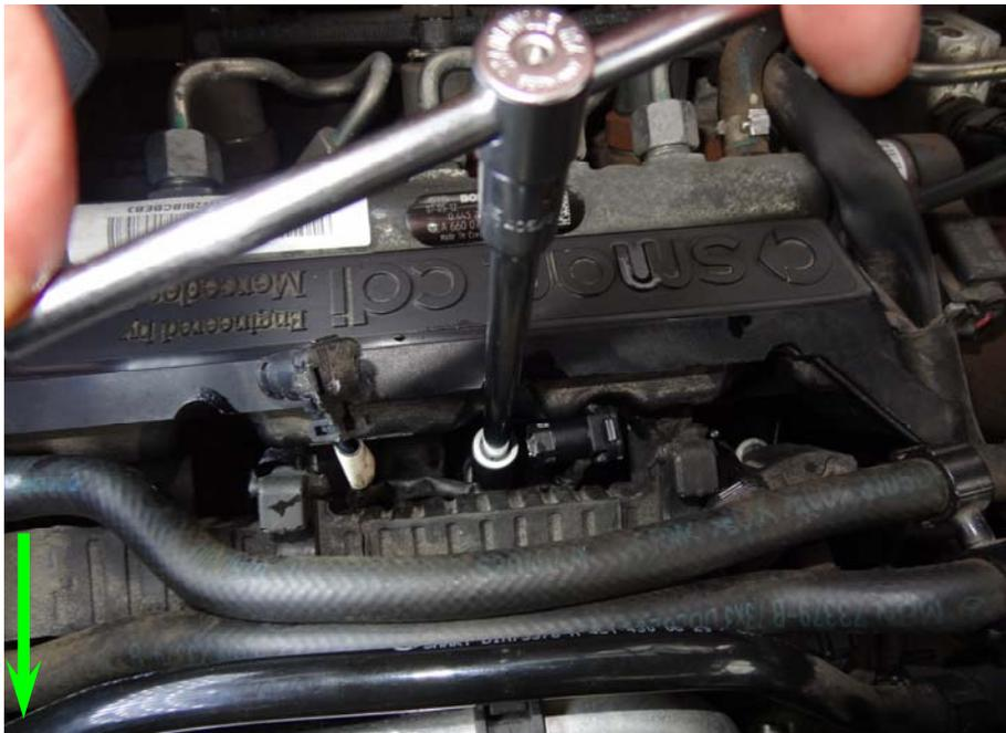
5. Wenn das Gewinde vollständig herausgeschraubt wurde (relativ lang), klemmt die Kerze oft mit dem Schaft in der Gewindebohrung. Unter Zuhilfenahme einer Zange kann dieses knifflige Unterfangen gemeistert werden.
