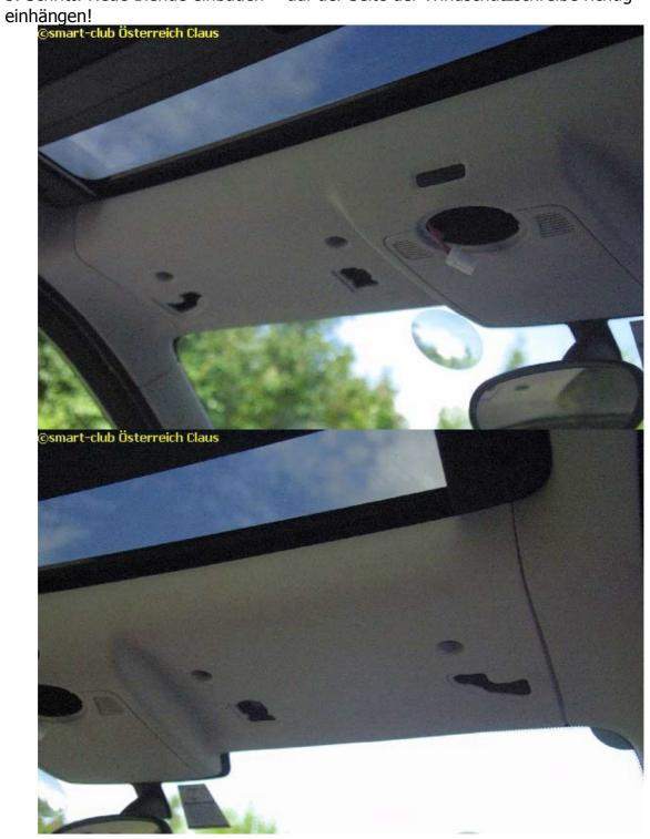
6. Schritt: Lager für Sonnenblenden anschrauben (auf links und rechts achten)
