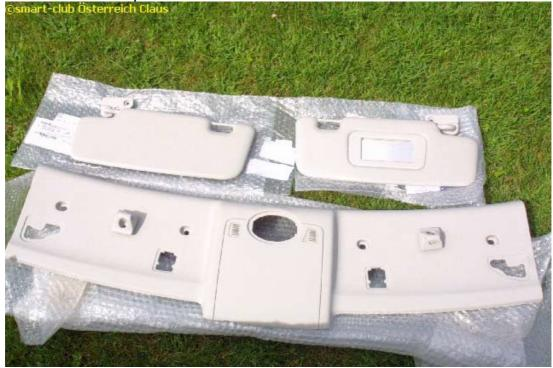
3. Schritt Alte Sonnenblenden demontieren – sechs Schrauben (T20 und T25), Abdeckung für Airbagkontrollleuchte ausklipsen und in neue Blende einklipsen, ebenso Innenleuchte
