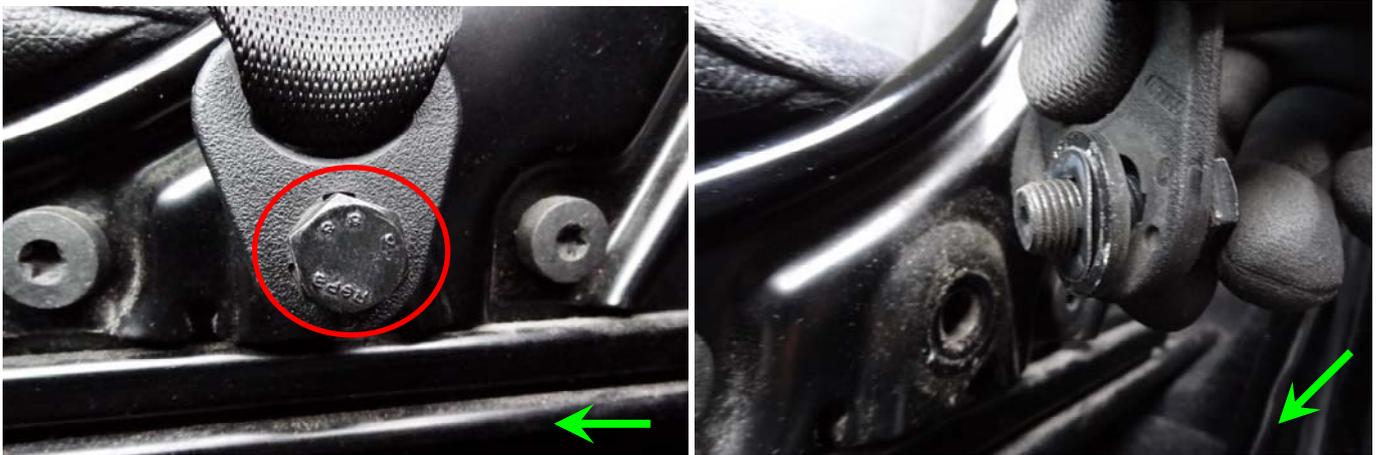
2. Sitz an vorderen Anschlag führen und Torx45 Schrauben am hinteren Ende der Schienen lösen.
