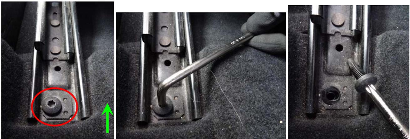
3. Sitz an den hinteren Anschlag führen und vordere Torx50 lösen. Ein 15mm Maul- oder Ringschlüssel zum Gegenhalten der Mutter auf der Unterseite ist erforderlich.
